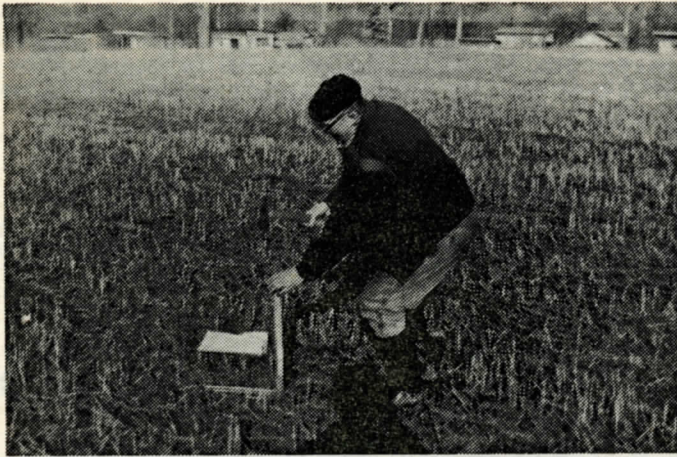
Die Baugrund-Untersuchung erfolgte durch Rammsonden bis ca. 5 m Tiefe, an denen dann der Erdstoffkern sichtbar und auswertbar ist.
